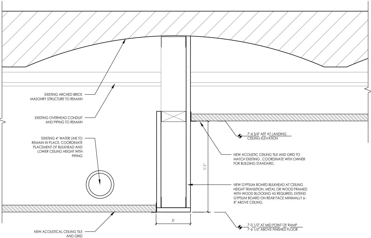
SECTION DETAIL AT CEILING HEIGHT TRANSITION
